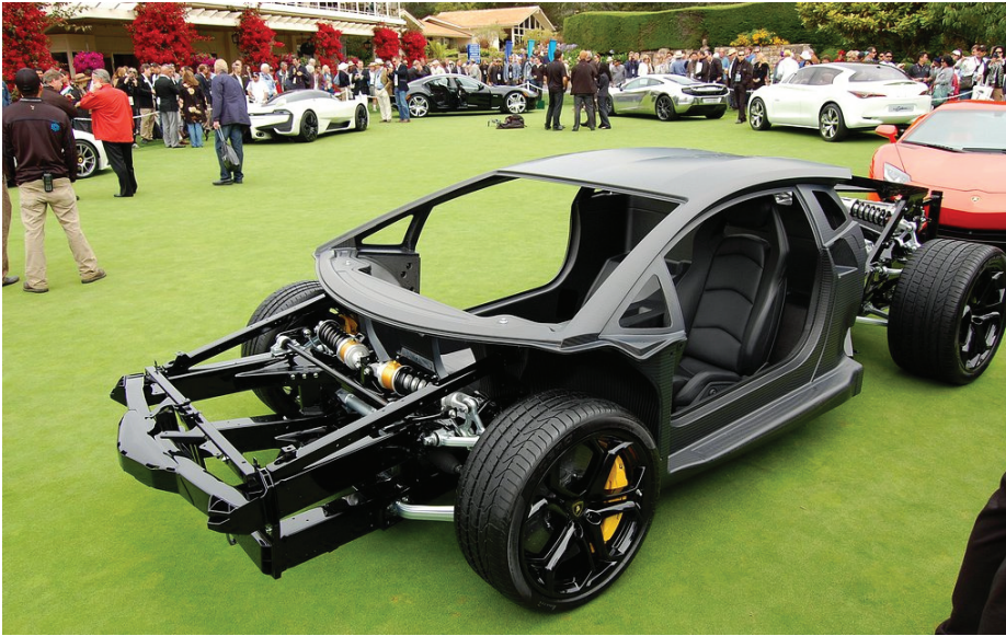
Figure045 "Full Monocoque - Lamborghini Aventador"
